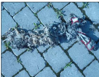
Dieser Putzlappen wickelte sich um die Abwasserpumpe in Ratzenhofen und brachte diese zum Stillstand.
